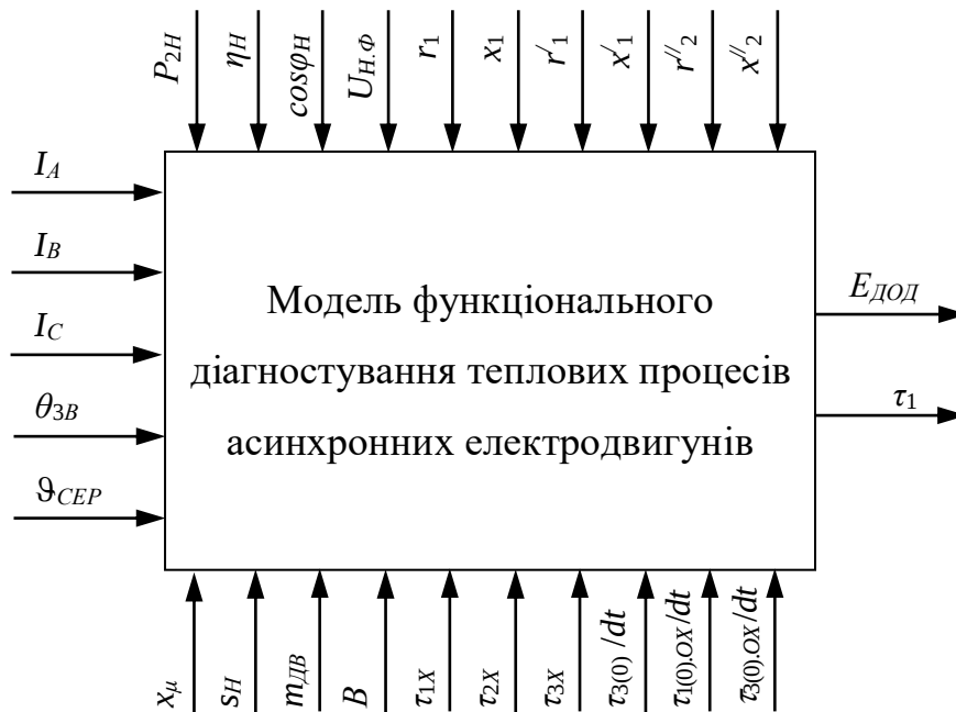
Рис. 12. Структурна схема моделі функціонального діагностування асинхронного електродвигуна за температурою сталі та силою струму статора
