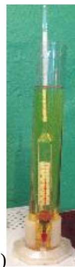
Рис. 3. Експериментальна лабораторна установка: а) контрольні необроблені і оброблені ультразвуком проби, б) віскозиметр ВПЖ-4(ДСТУ ГОСТ 33-2003, ИСО 3104-94), в) ареометр (ГОСТ 3900-85)
