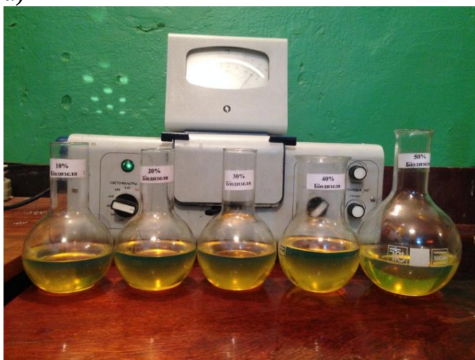
Рис. 2. Експериментальна лабораторна установка: а) фотокалориметр з приготовленими пробами, б) водяний термостат УН-8 з віскозиметром ВПЖ- 4
