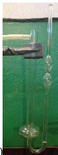
Рис. 3. Експериментальна лабораторна установка: а) контрольні необроблені і оброблені ультразвуком проби, б) віскозиметр ВПЖ-4(ДСТУ ГОСТ 33-2003, ИСО 3104-94), в) ареометр (ГОСТ 3900-85)
