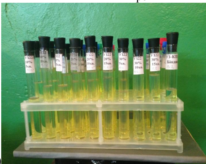
Рис. 3. Експериментальна лабораторна установка: а) контрольні необроблені і оброблені ультразвуком проби, б) віскозиметр ВПЖ-4(ДСТУ ГОСТ 33-2003, ИСО 3104-94), в) ареометр (ГОСТ 3900-85)
