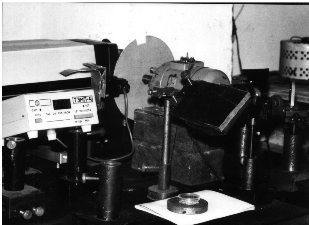
Рис. 3.5. Прибор контроля числа импульсов и скорости вращения.
