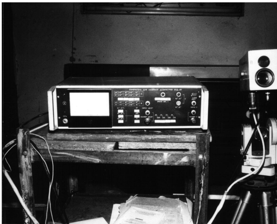
Рис. 3.6. Прибор контроля плотности энергии излучения.
