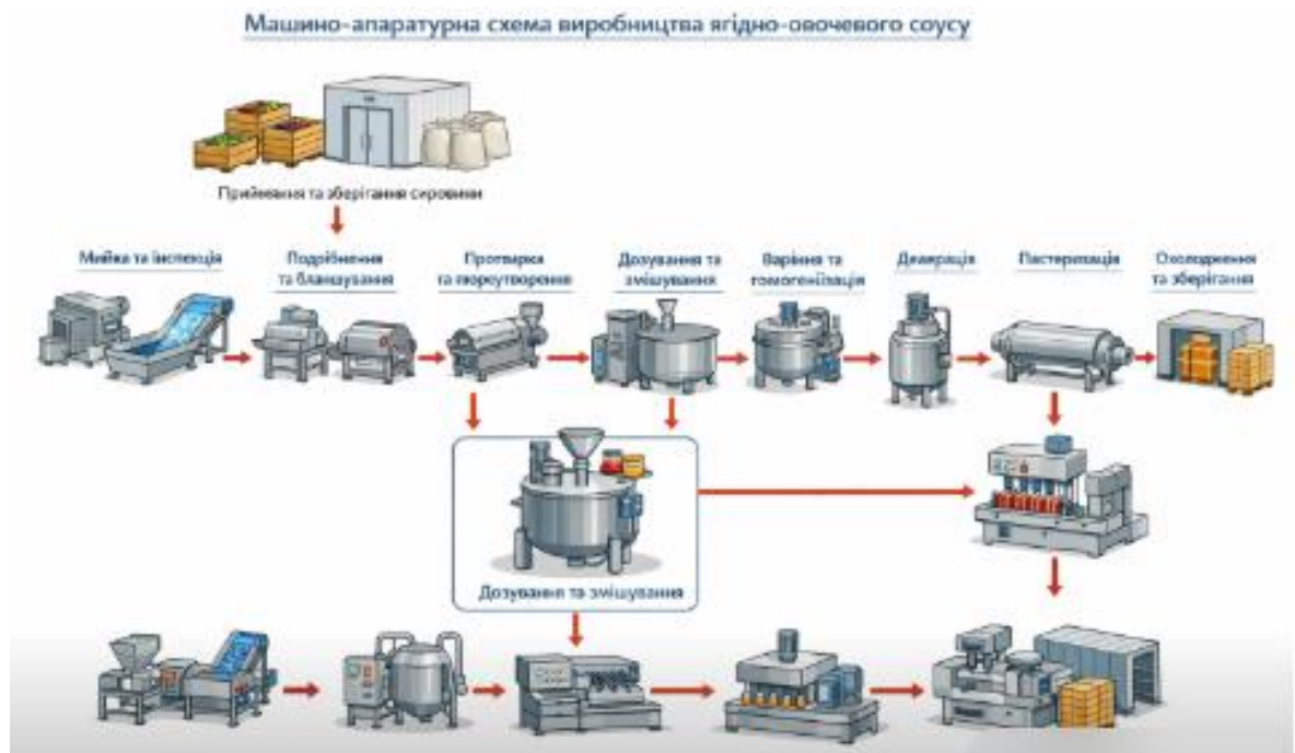
Рис. 4.3 Машино-апаратурна схема виробництва ягідно-овочевого соусу гарбузово-обліпиховий з інуліном
