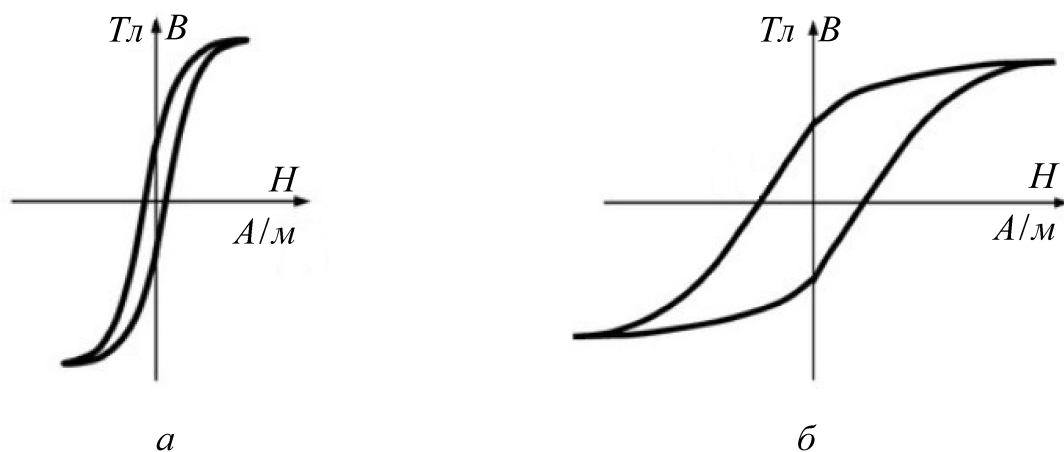
Рисунок 3.11 – Петлі гістерезису магнітом'якого (а) і магнітотвердого (б) матеріалів
