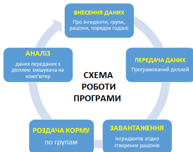
Рис.1 Схема роботи програми приготування кормів годівлі тварин
