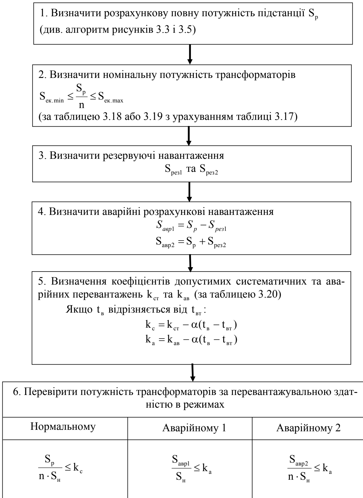
Рисунок 3.9 - Алгоритм вибору числа та потужності силових трансформаторів
