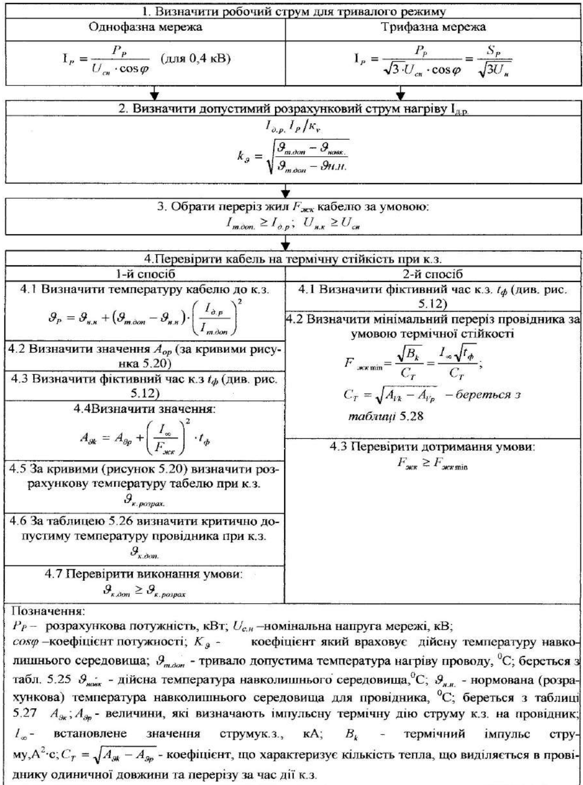
Рисунок 5.19 – Алгоритм вибору та перевірки провідників та кабелів
