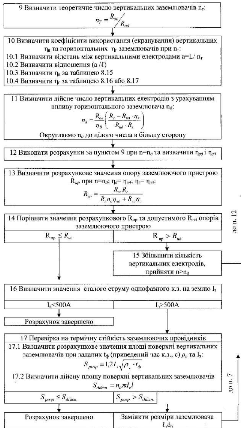
Рисунок 8.12.2 – Продовження алгоритму розрахунку заземлюючого пристрою
