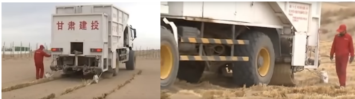
Рис. 2 Спеціальні машини для укладання солом'яних канатів
