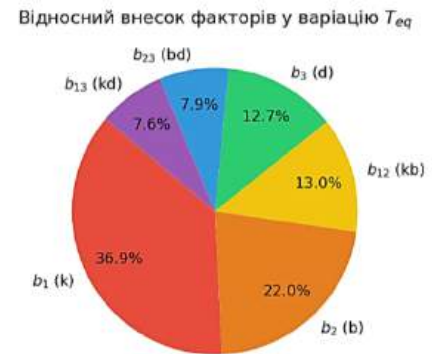
Рис. 3. Параметрична чутливість T_{eq} : абсолютні значення коефіцієнтів верифікованої регресійної моделі (ліворуч) та відносний внесок головних ефектів (праворуч)
