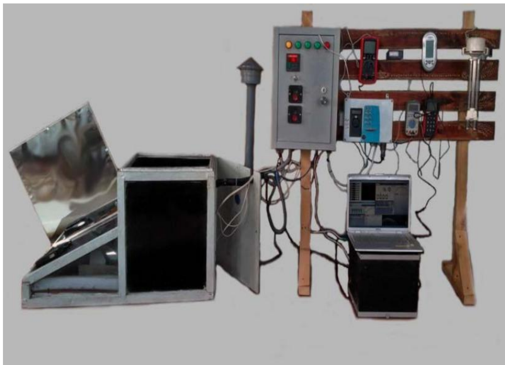
Рис. 2.1. Загальний вигляд лабораторної установки для дослідження параметрів геліосушарки з тепловим акумулятором та плоским дзеркальним концентратором
