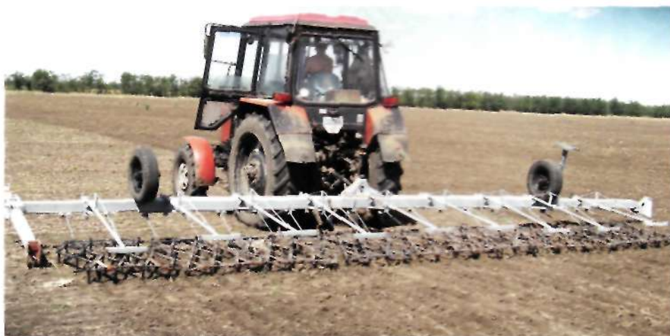
Фото 2. Машинно-тракторний агрегат для обробітку пару в роботі
