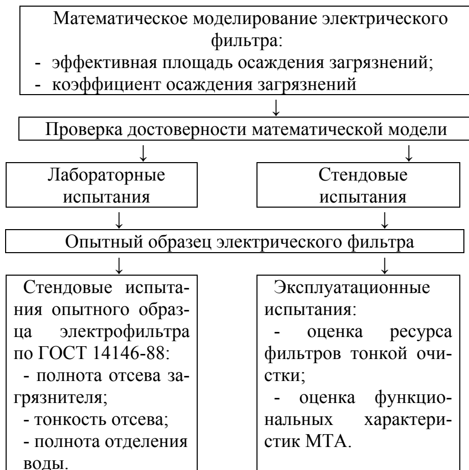
Рисунок 3.5 Алгоритм создания электрофильтра.
