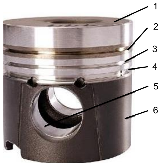
Рис. 2.11. Будова поршня: 1 – днище поршня; 2 – канавка верхнього компресійного кільця; 3 – канавка нижнього компресійного кільця; 4 – канавка маслоснізного кільця; 5 – бобишки поршневого пальця; 6 – юбка поршня
