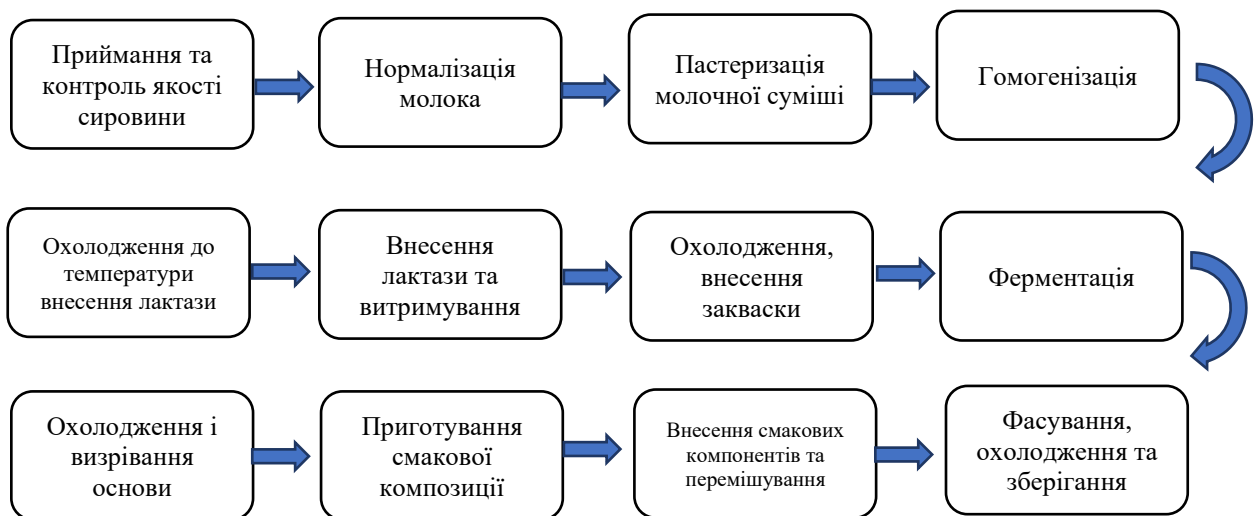
Рис. 3.1. Етапи технологічного процесу виробництва безлактозного йогуртового соусу
