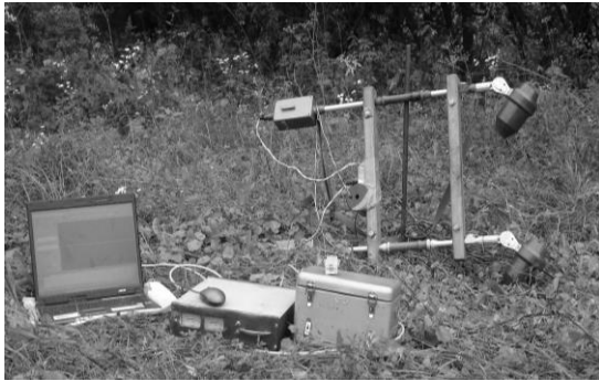
Рис. 30. Зовнішній вигляд апаратної частини магнітометра-градієнтометра КМ-8
