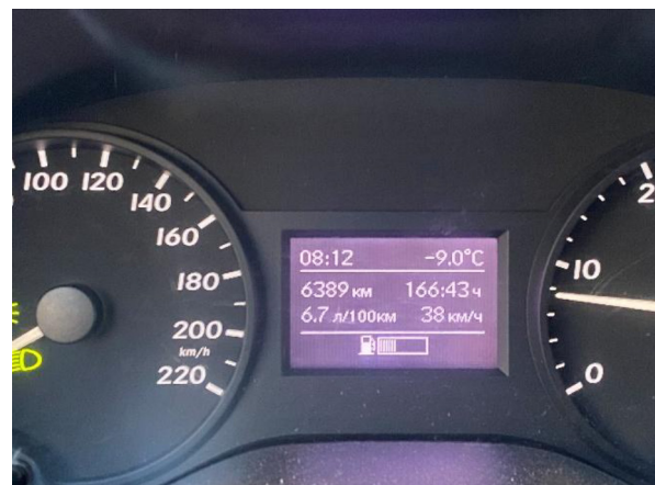
Рис. 4. Витрата палива на автомобілі Мерседес Віто 116СДІ, грудень 2025 р. – січень 2026 р., режим експлуатації – місто
