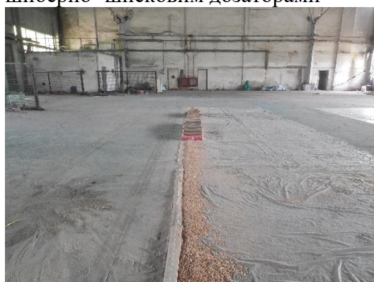
Валок суміші (10 м). Видача зерна з барабанно-заслінковим і піску з шибєрно- шнековим дозаторами
