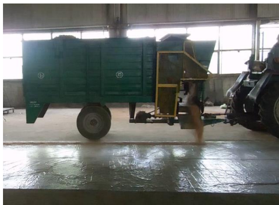
Видача висівок бункером з шибєрно-шнековим дозатором
