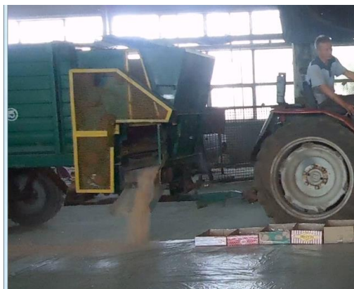
Видача суміші бункером: зерна з барабанно-заслінковим і піску з шибєрно- шнековим дозаторами
