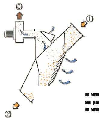
Рис. 7 .Пневмосепаратор Zanin PA-I и схема его работы
