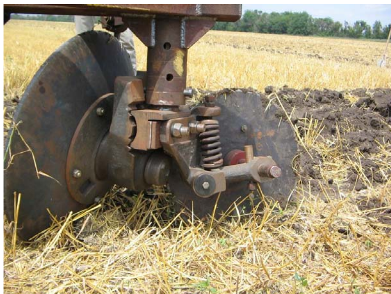
Рис.3. Механизм крепления диска к стойке
