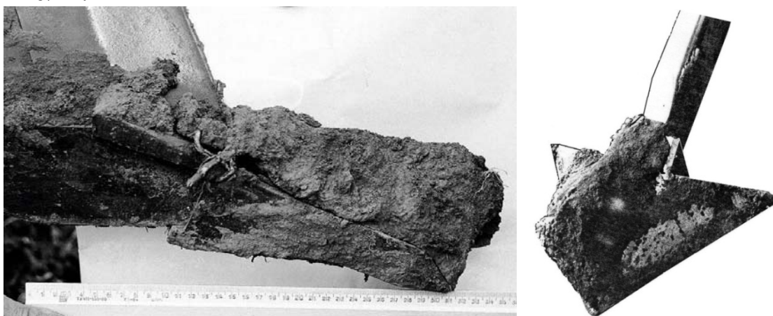
Рис. 2. Вид тела из переуплотненной почвы на рабочей поверхности долота (а) и лапы чизельного плуга (б)
