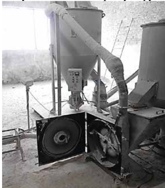
Рис. 2. Кормоприготувальна установка БМК-1
