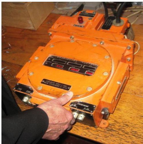
Рис. 2.17. Определение концентрации механических примесей в СОЖ прибором контроля чистоты ПКЖ-904В.
