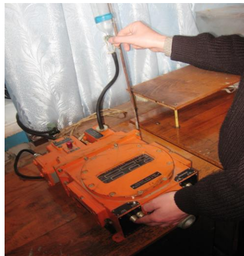
Рис. 2.17. Определение концентрации механических примесей в СОЖ прибором контроля чистоты ПКЖ-904В.
