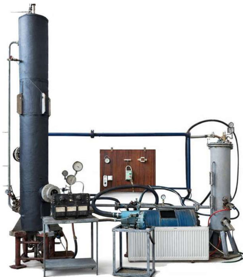
Рис. 2. Фотографія експериментального стенду теплоелектрогенеруючого агрегату на базі рідинно-парового струминного апарату
