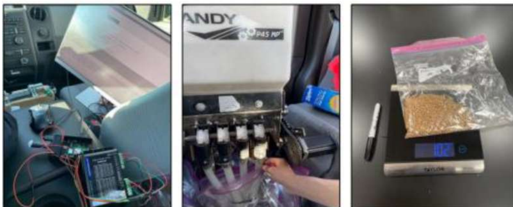
Рис. 8. Оцінювання подачі насіння висівним апаратом
