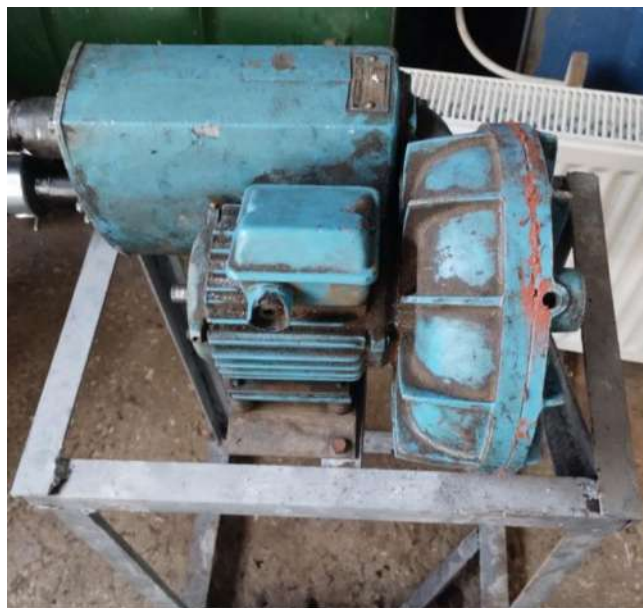
Рис. 3. Фото турбогенератора з глушником
