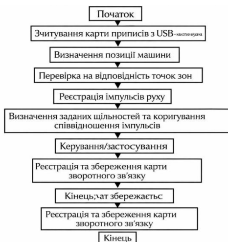
Рис. 4. Схема управління мехатронним процесом
