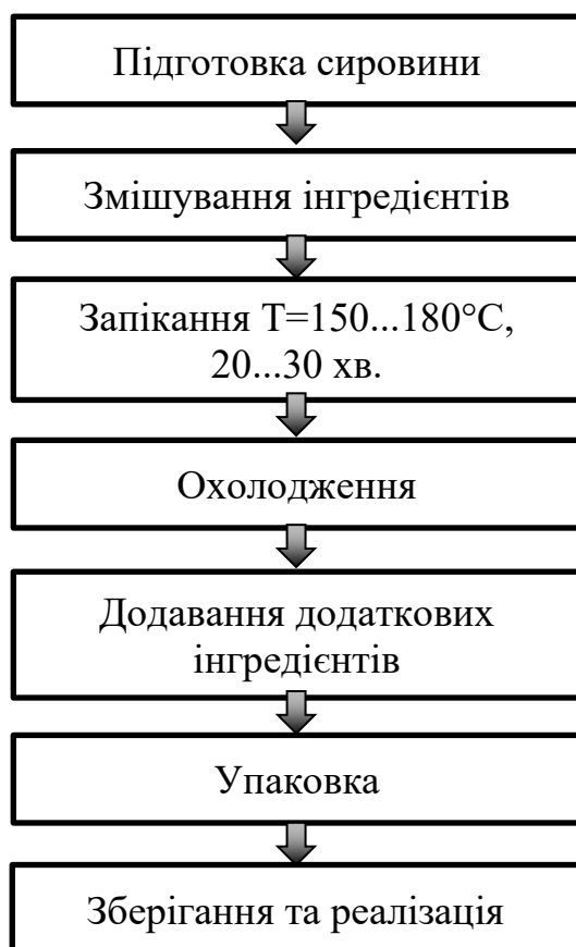
Рис. 4.1. Технологічна схема виробництва граноли
