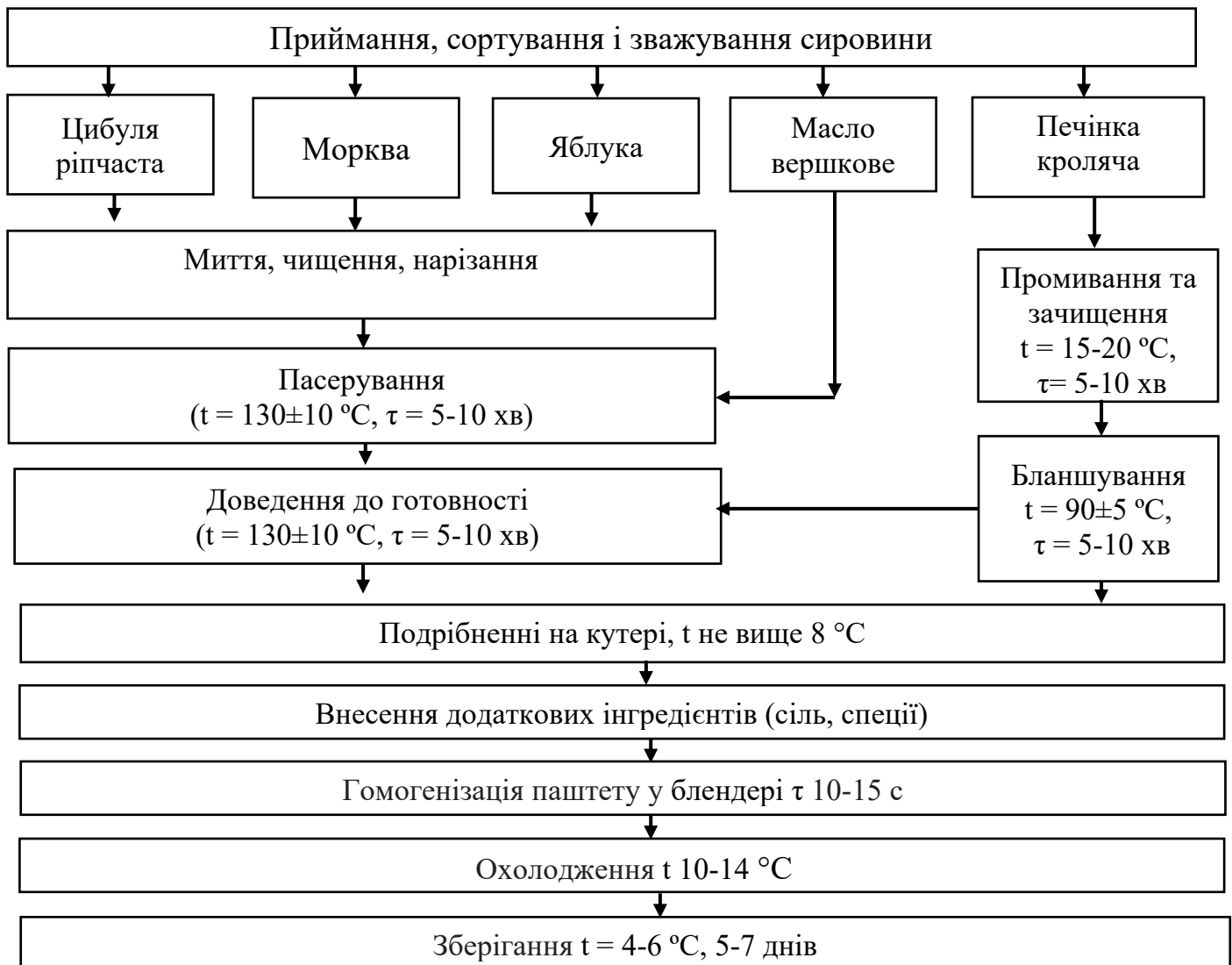
Рис. 4.1. Принципова технологічна схема виробництва паштету печінкового.
