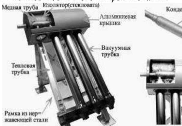
Рис. 1. Будова вакуумного СК «Атмосфера»
