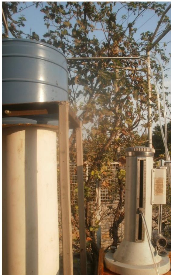
Рис.3.3 Вимірювання трубкою Піто-Прандтля з мікрометром МКВ-250
