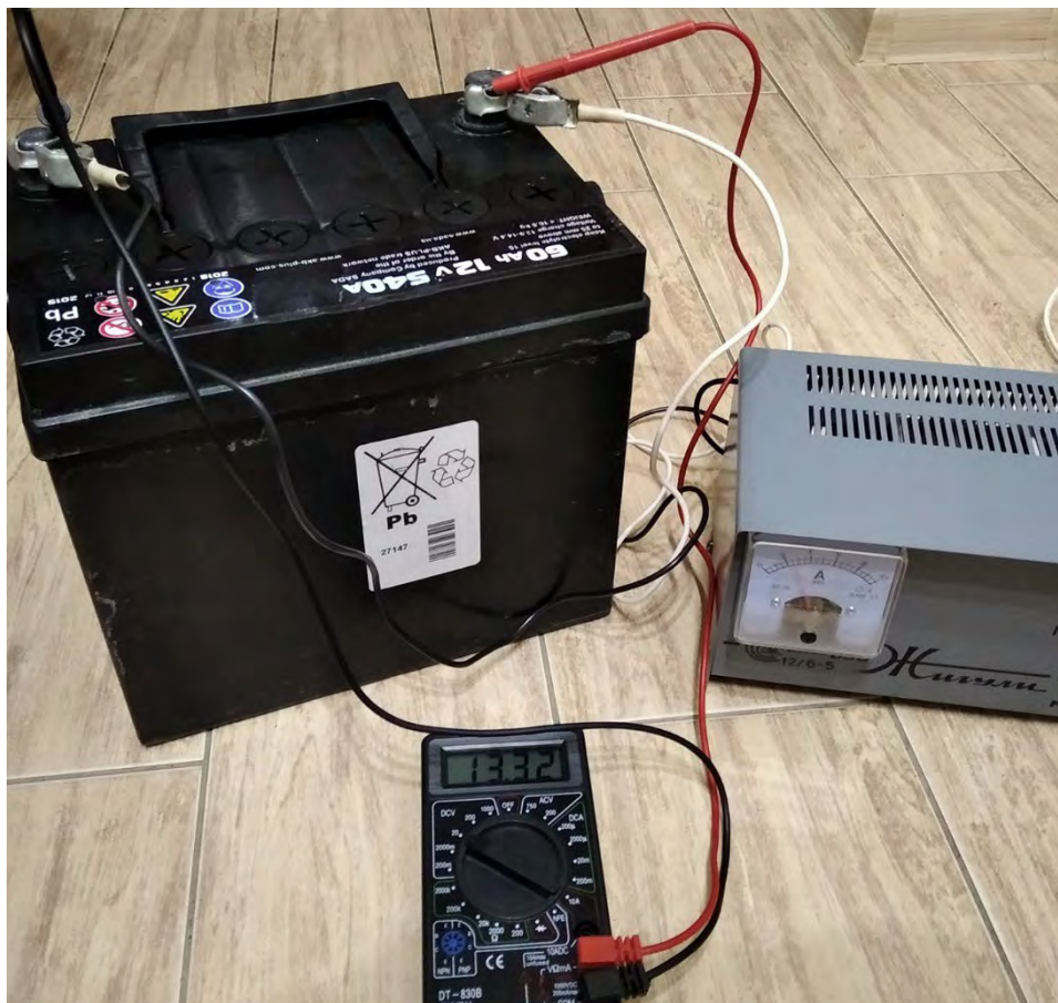
Рис. 4. Зарядження акумуляторної батареї SADA OPTIMA із використанням ВЗУ «Жигулі»
