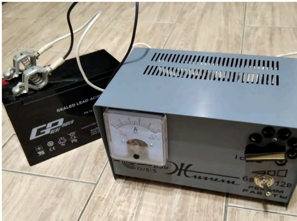
Рис. 1. Зарядження акумуляторної батареї GREAT POWER із використанням ВЗУ «Жигулі»
