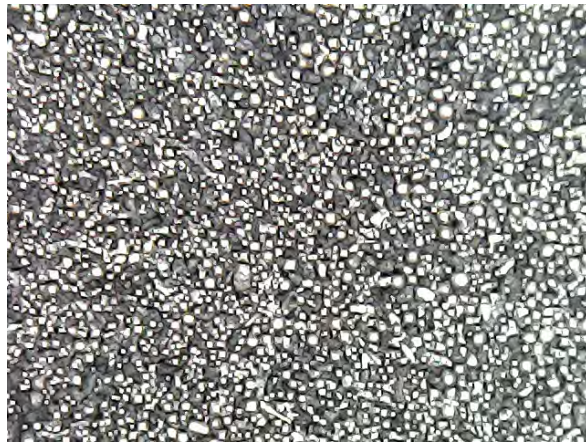
Рис. 2. Мікроструктура розробленого композиційного матеріалу, х 300.
