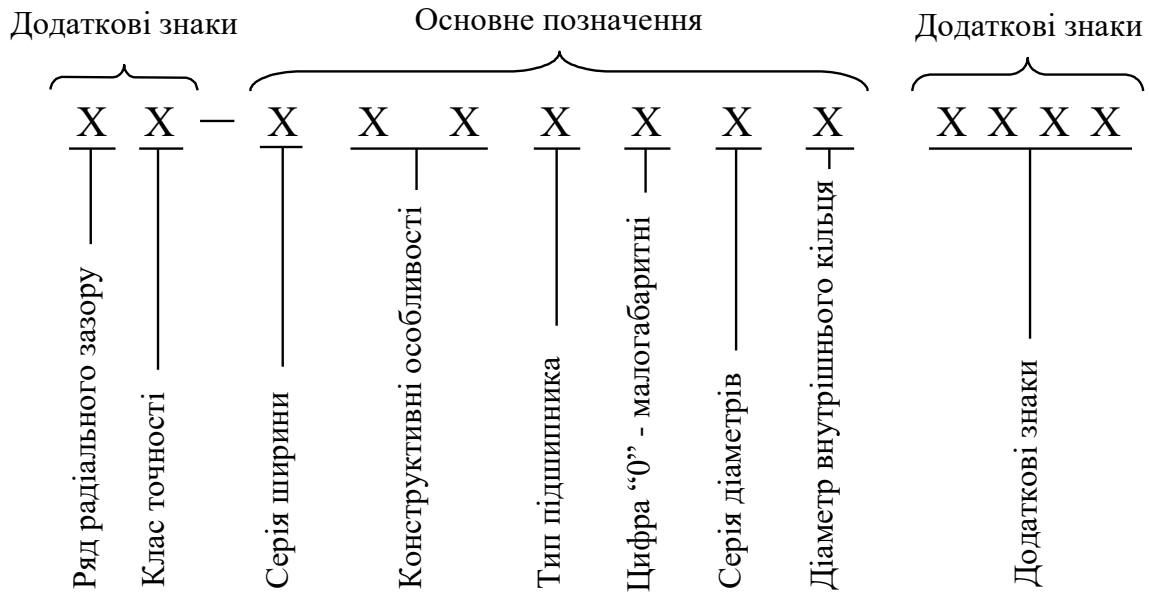
Рисунок 5.4 – Позначення підшипників кочення з діаметром внутрішнього кільця до 10 мм
