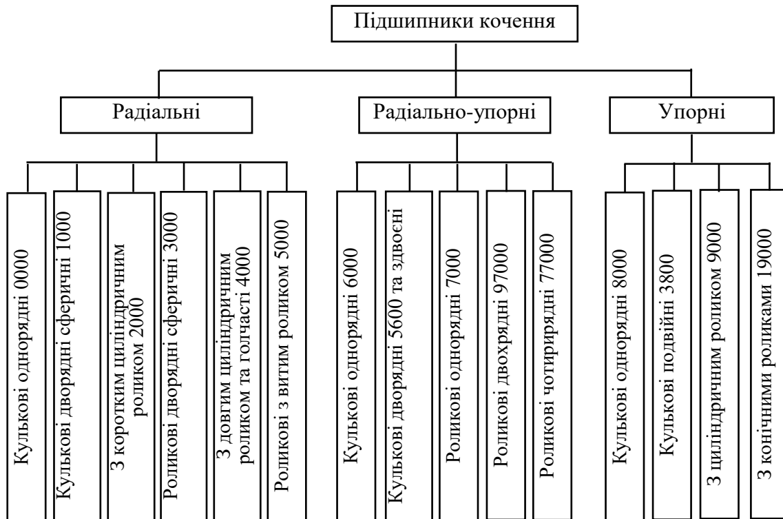
Рисунок 5.3 – Класифікація підшипників кочення
