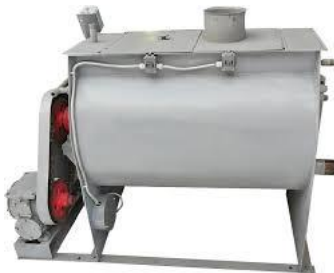
Рисунок 2.2 – Секційний тістоприготувальний агрегат И8-ХТА-6.
