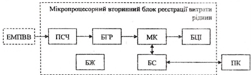
Рис. 1. Структурна схема мікропроцесорного вторинного блоку реєстрації у складі електромагнітного пристрою вимірювання витрати рідини: ЕМПВВ – електромагнітний пристрій вимірювання витрати; ПСЧ – перетворювач струму в частоту; БГР – блок гальванічної розв'язки; МК – мікроконтролер; БЦІ – блок цифрової індикації; БС – блок сполучення з комп'ютером; БЖ – блок живлення; ПК – персональний комп'ютер
