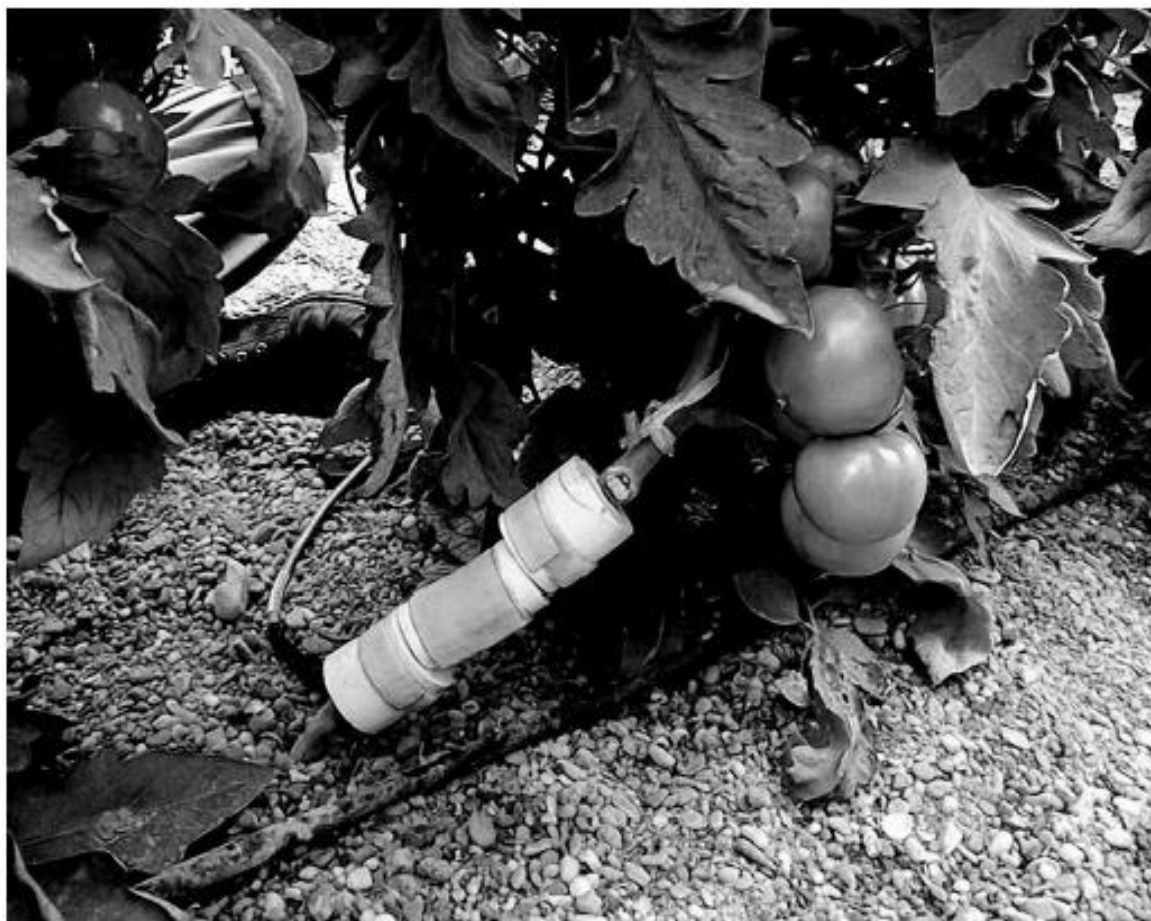
Рис. 4.46. Датчик измерения водного потока, установленный на стебле растения
