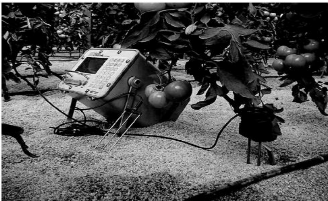
Рис. 4.42. Определение влажности почвы при помощи динамического рефлектометра
