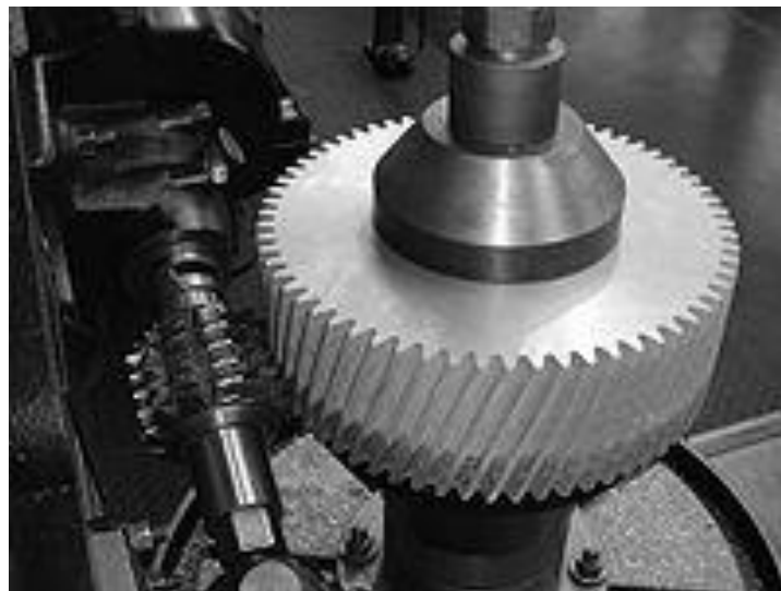
Рисунок 3.1 – Нарізання зубчастого колеса методом обкатування на зубофрезерному верстаті за допомогою черв'ячної фрези.
