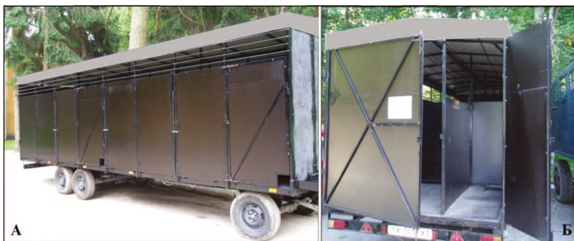
Мал. 5.2 Зовнішній (А) та внутрішній (Б) вигляд автомобіля для перевезення диких тварин (мисливсько-спортивний клуб «Сокіл», Рівненська область)
