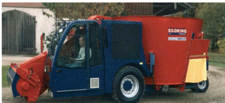
Рисунок 4. Самохідний кормороздавач-змішувач фірми Siloking
