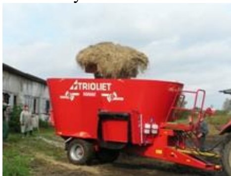
Рисунок 2. Кормороздавач-змішувач фірми Trioliet із стороннім завантаженням компонентів кормосуміші
