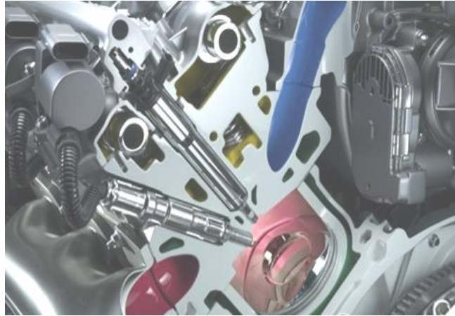
Рис. 2. Розміщення форсунки та свічки запалювання
