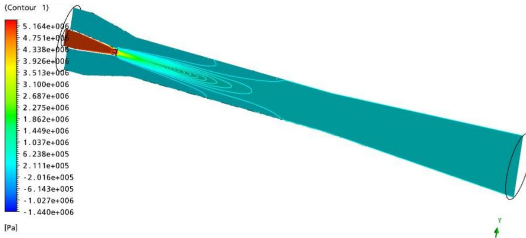
Рис. 6. Картина распределения гидростатического давления в струйном аппарате для питательного насоса
