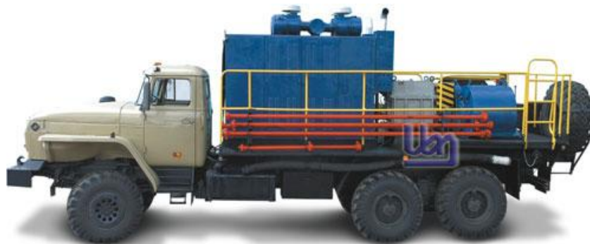
Рис 2. Насосная установка УН-450х700
