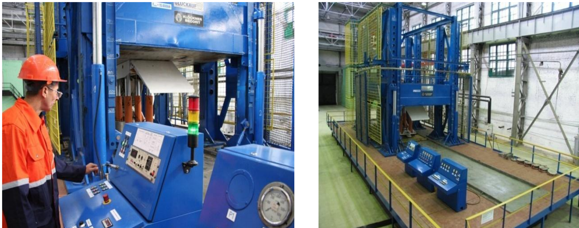
Рис. 1. Испытания секции крепи на испытательном стенде «Gluckauf»
