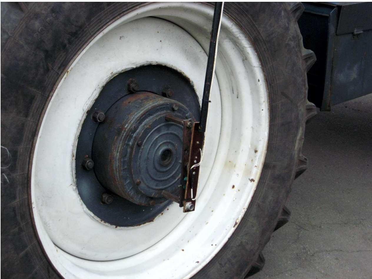
Рис. 3.10. Переднє колесо трактора ХТЗ-160 з установленими герконами
