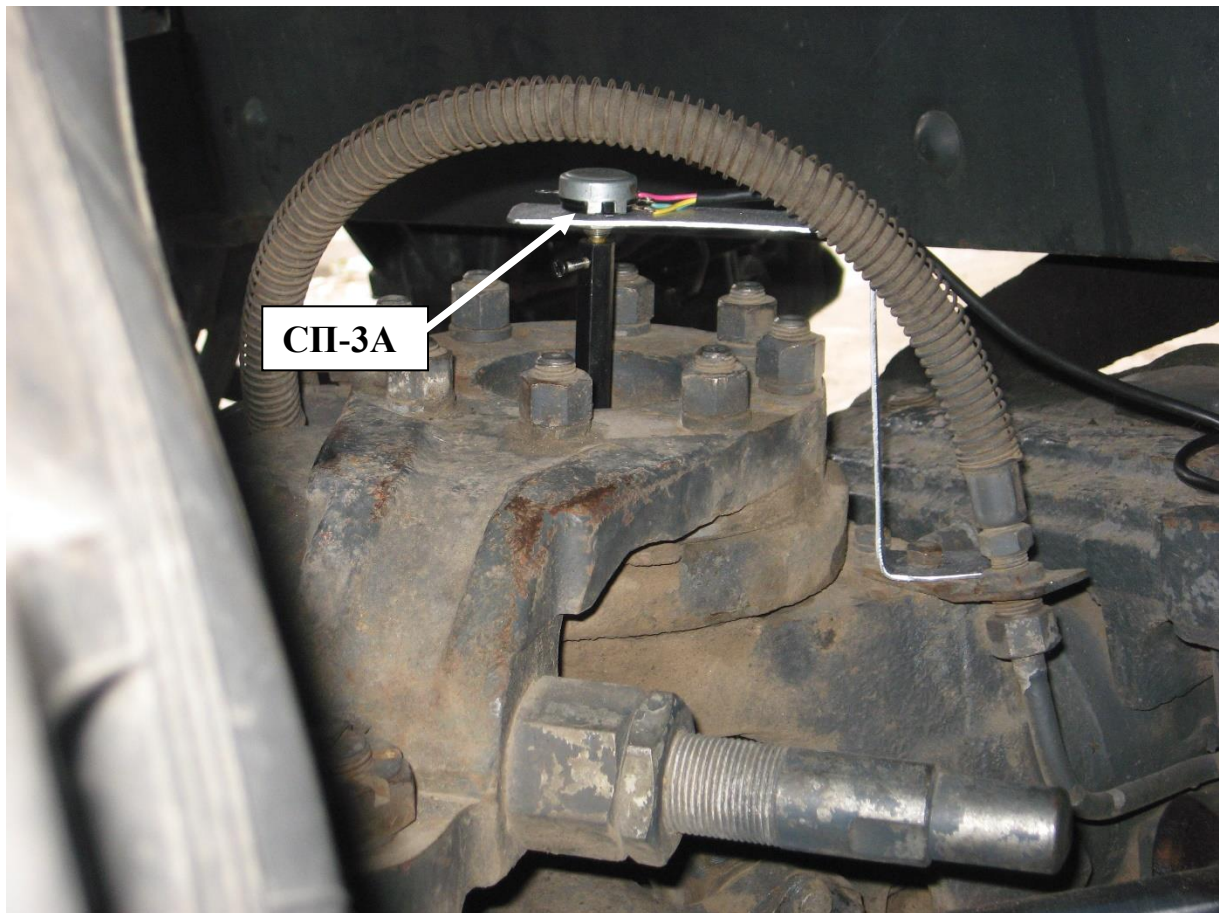
Рис. 3.11. Установка резистора СП-3А на передньому колесі трактора ХТЗ-160
