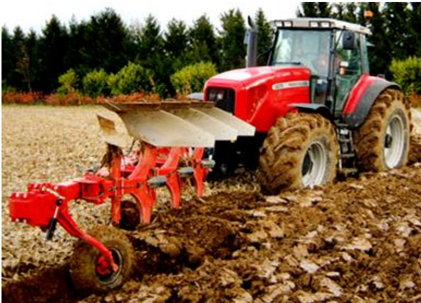
Рис. 1.6. Приклади розміщення опорного колеса фронтального плуга у борозні [80]
