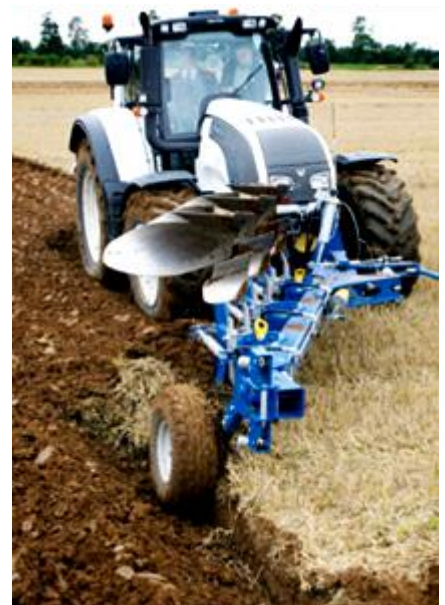
Рис. 1.6. Приклади розміщення опорного колеса фронтального плуга у борозні [80]
