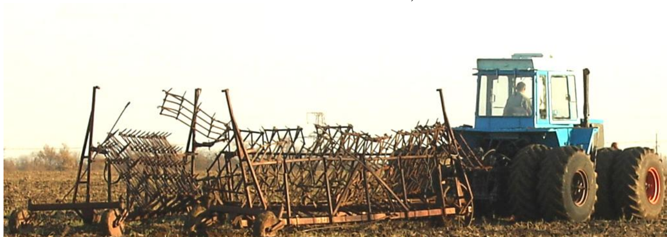
Рис.17 – Боронувальний МТА на основі ХТЗ-160 зі здвоєними шинами 23,1R26 та зчепу СГ-21
