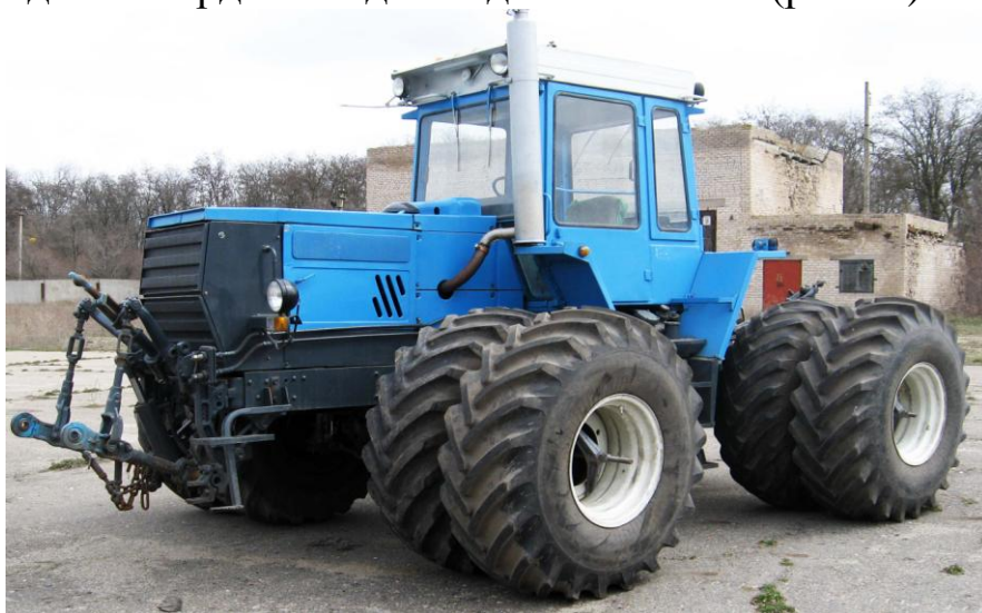
Рис.16 – Обладнання орно-просапного трактора серії ХТЗ-160 з двоєними шинами типорозміру 23,1R26
