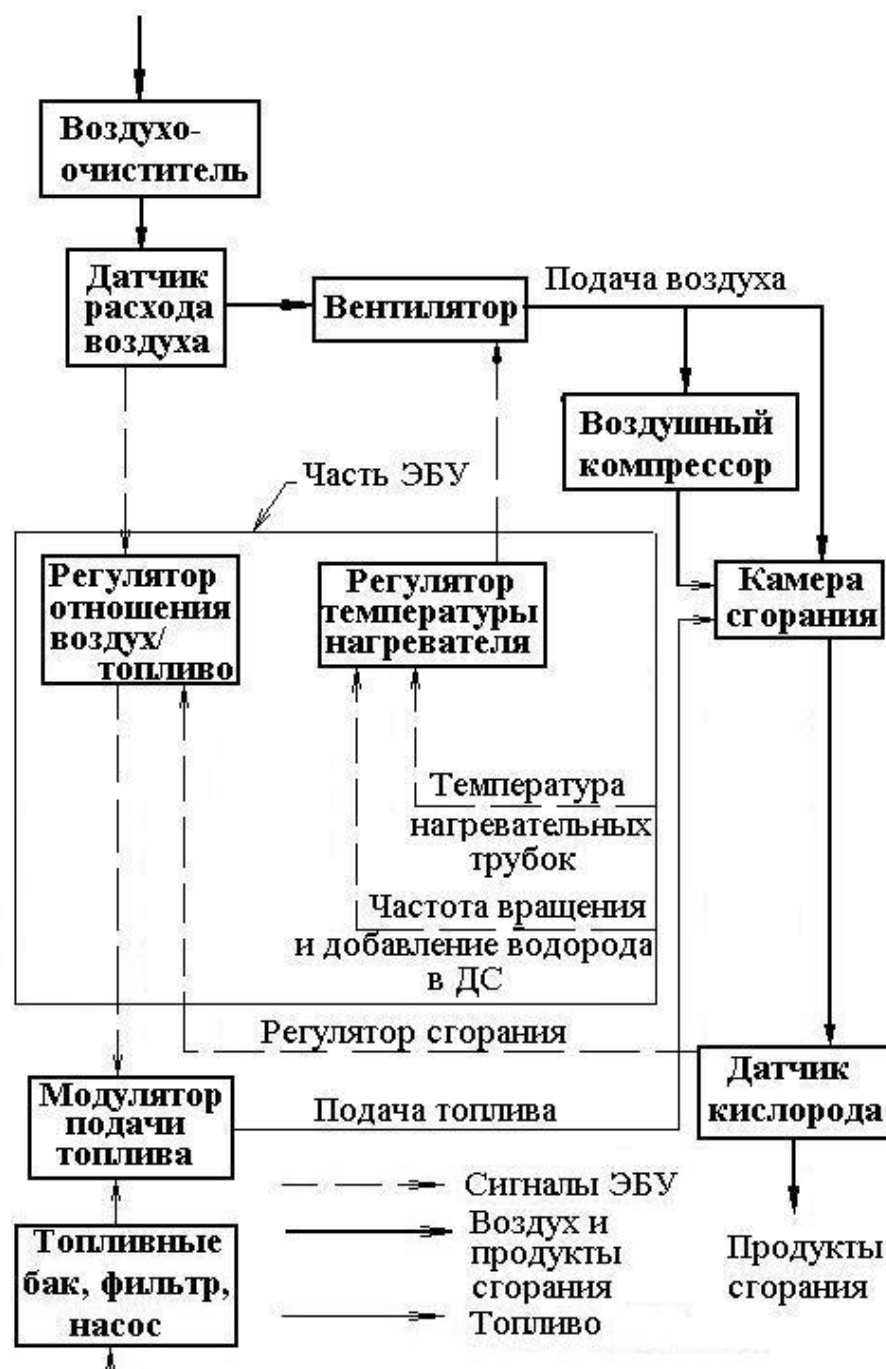
Рис. 1.9. Схема организации процесса сгорания в двигателе Стирлинга
