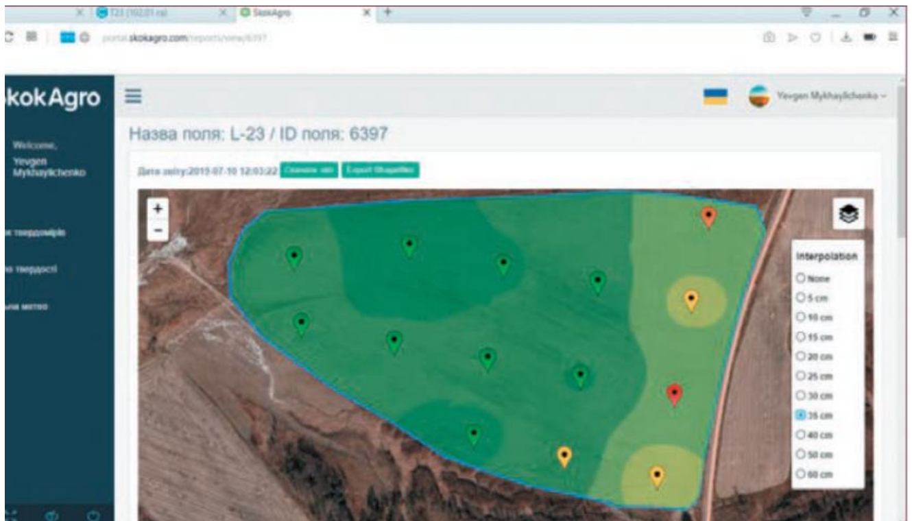
Рис. 5. Фрагмент карти точок вимірювання твердості ґрунту цифровим пенетрометром
