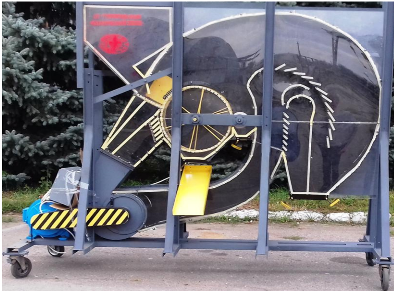
Рис. 1. Лабораторно-виробничий стенд пневморешітного сепаратора олійної сировини соняшнику
