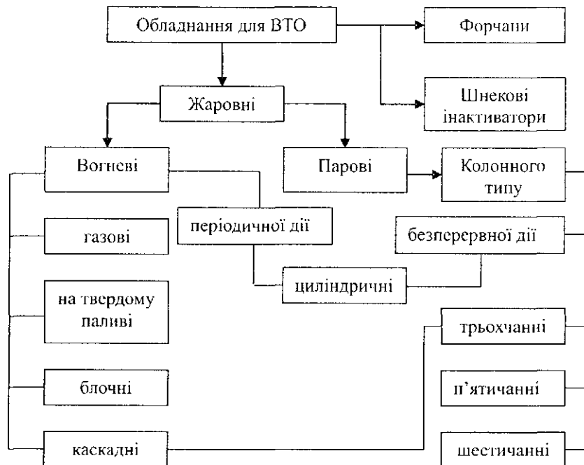
Рис. 3.50. Класифікація обладнання для волого-теплової обробки м'ятки
