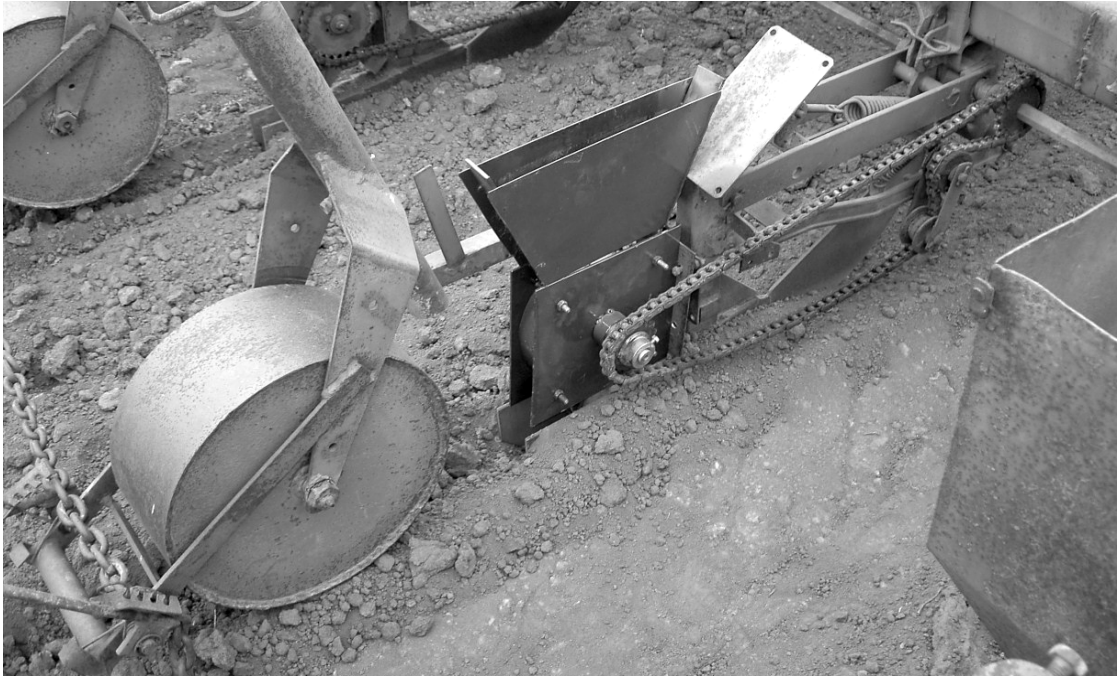
Рис. 3.9 – Висівний апарат у складі сівалки ССК-4 в агрегаті з трактором МТЗ-82 у виробничих умовах ДПДГ «Мелітопольське».
