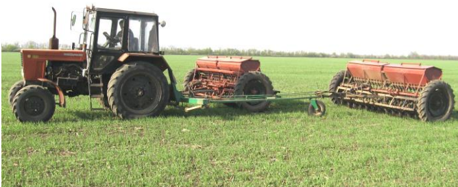
Рис. 8. Двомашинний МТА на підживленні сходів озимої пшениці
