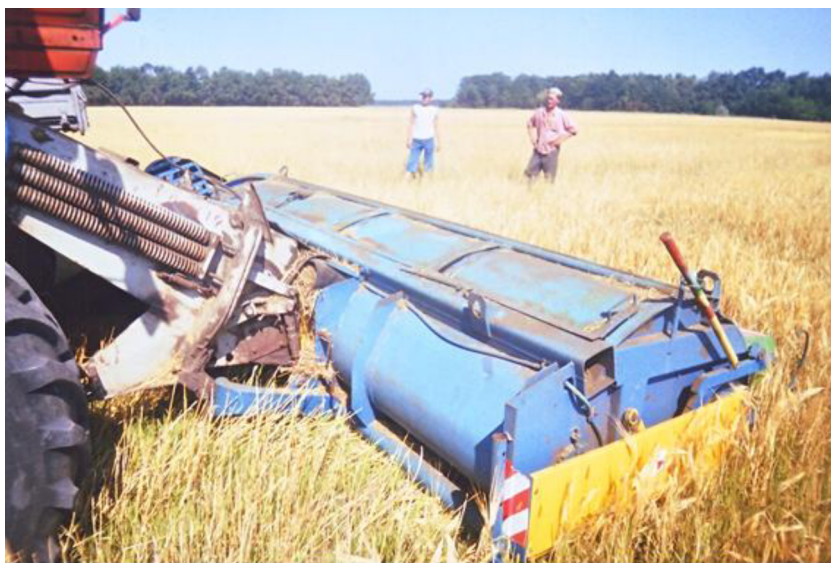
Рис. 2. Обчісувальний пристрій конструкції УкрНІМЕСГ
