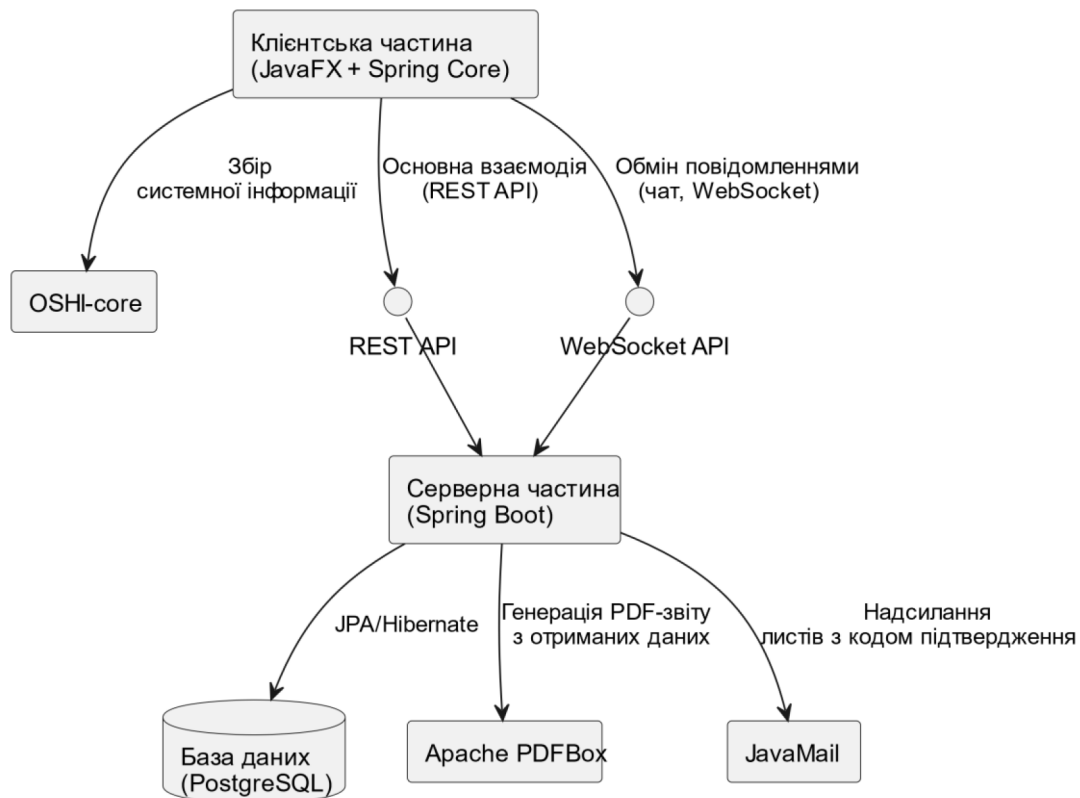
Рис. 1. Діаграма компонентів архітектури системи моніторингу
