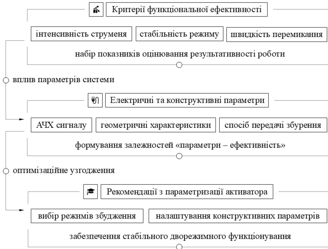
Рис. 4. Структурно-логічна схема формування критеріїв і параметризації п'єзоелектричного активатора для дворежимного функціонування
