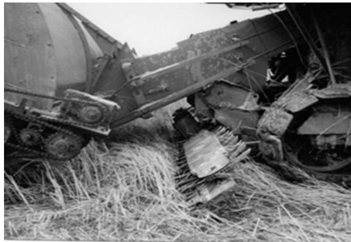
Рис. 4. Різальний пристрій обчісувального модуля
