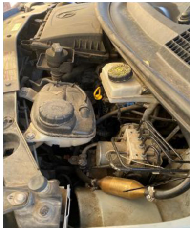
Рис. 2. Спосіб встановлення пристрою для магнітної обробки палива на автомобіль Мерседес Віто 116СДІ, 2017 р., об'єм мотора – 2,2 л, вид палива – дизель
