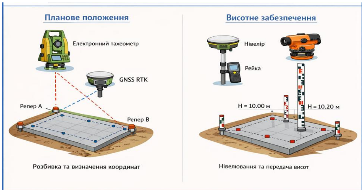
Рис. 2.3 – Схема планово-висотного геодезичного забезпечення улаштування фундаментної плити ФМ-1
