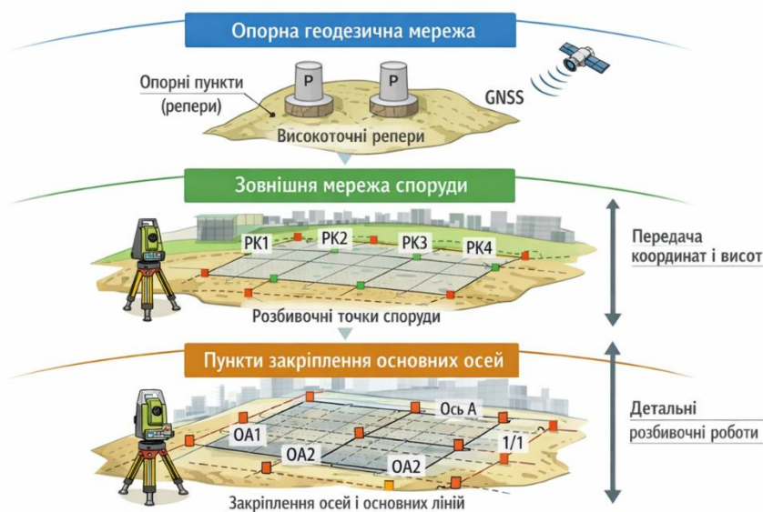
Рис. 1.3 – Ієрархія геодезичної мережі на будівельному майданчику
