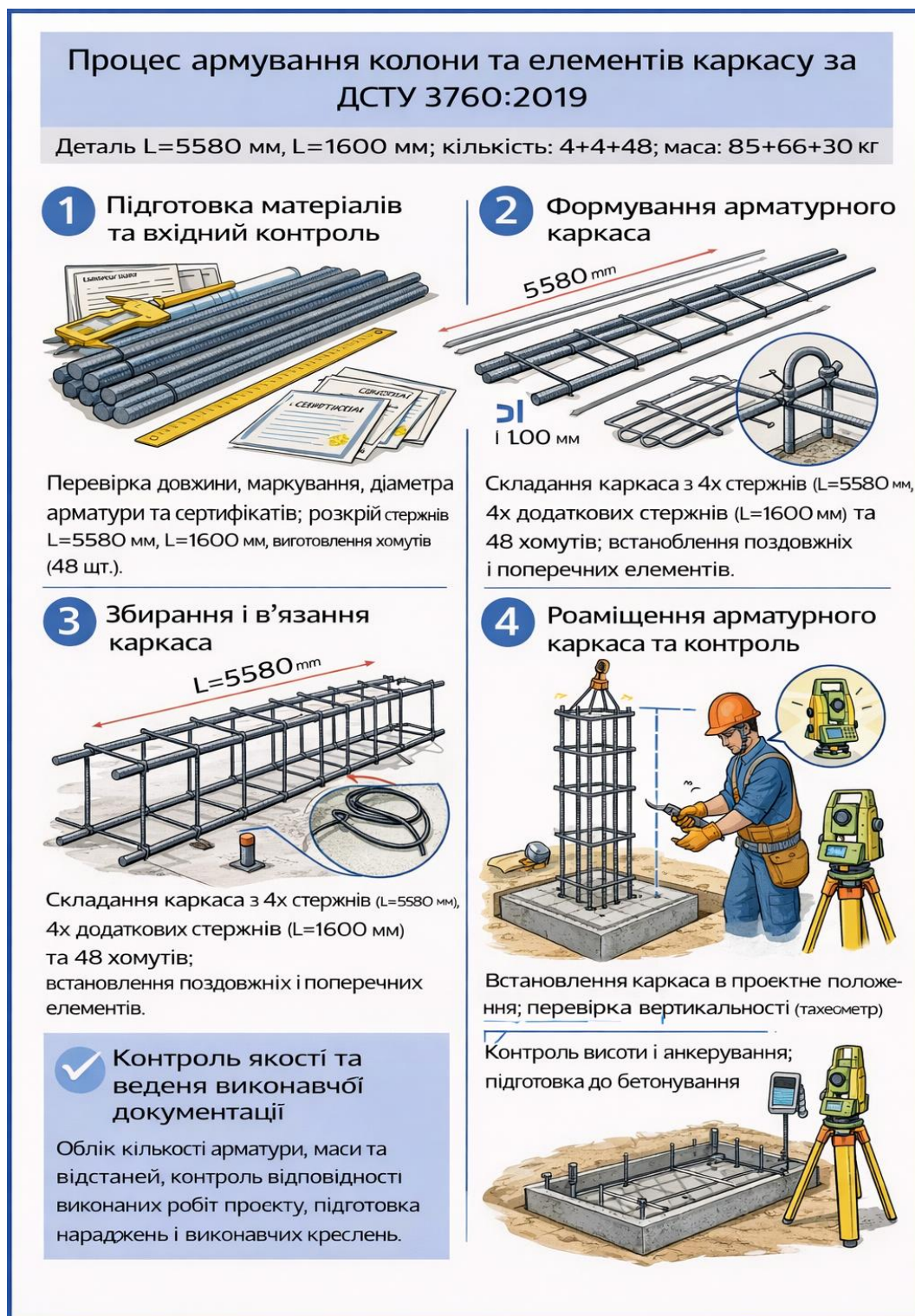
Рис. 2.7 – Процес армування колон
