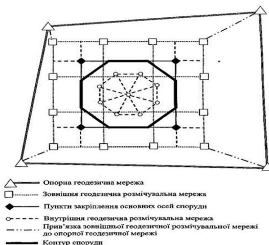
Рис. 1.2 – Типова схема геодезичної розмічувальної мережі будівельного майданчика [11]
