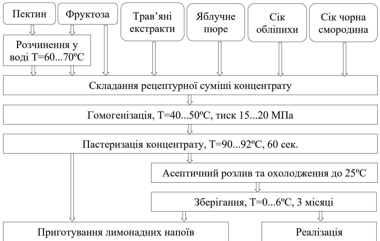
Рис. 4.5. Технологічна схема виробництва концентратів для натурального лимонадного напою з використанням трав'яних екстрактів і фруктово-ягідних компонентів.
