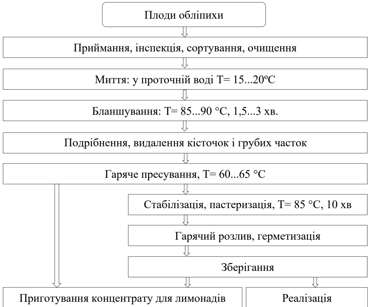
Рис. 4.4. Технологічна схема виробництва соку з плодів обліпихи.
