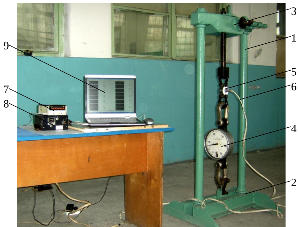
Рис. 3.11. Загальний вид тарувального стенда разом з вимірювальною апаратурою:
