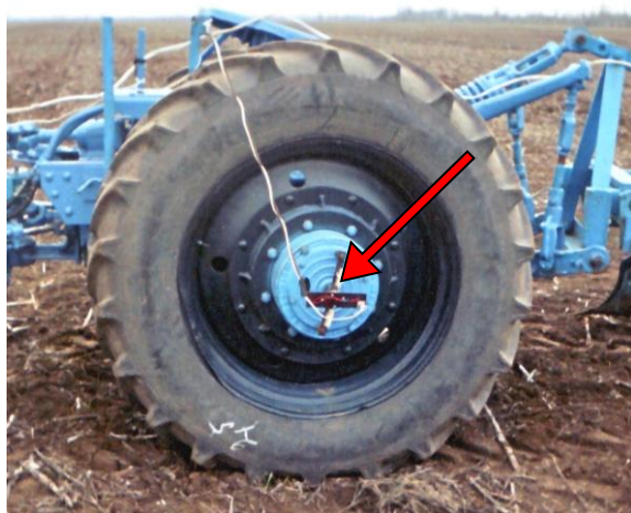
Рис. 3.7. Встановлення герконового давача на мосту технологічного модуля МЕЗ для визначення частоти обертання коліс.
