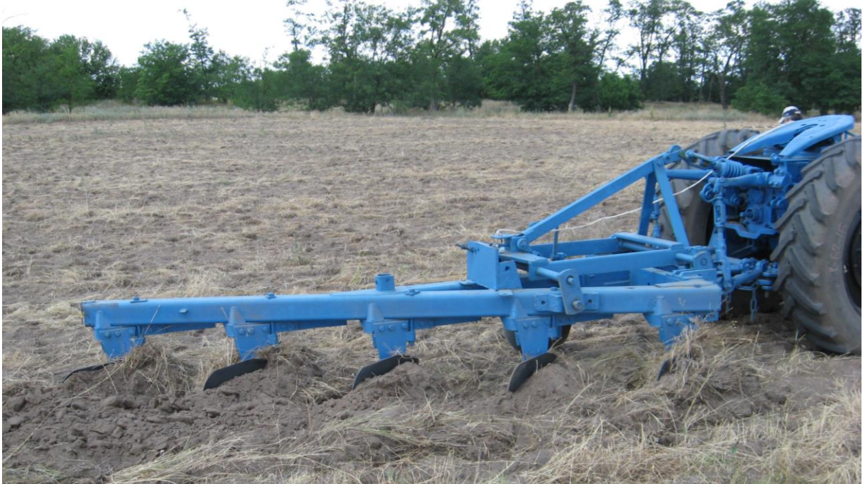
Рис. 3.4. Тензометричний навісний плуг ПЛН 5-35 в складі орного МТА на основі МЕЗ класу 1,4-3.
