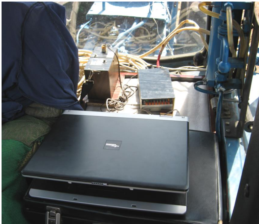
Рис. 3.15. Апаратно-реєструючий комплекс, розміщений в кабіні енергетичного модуля МЕЗ.
