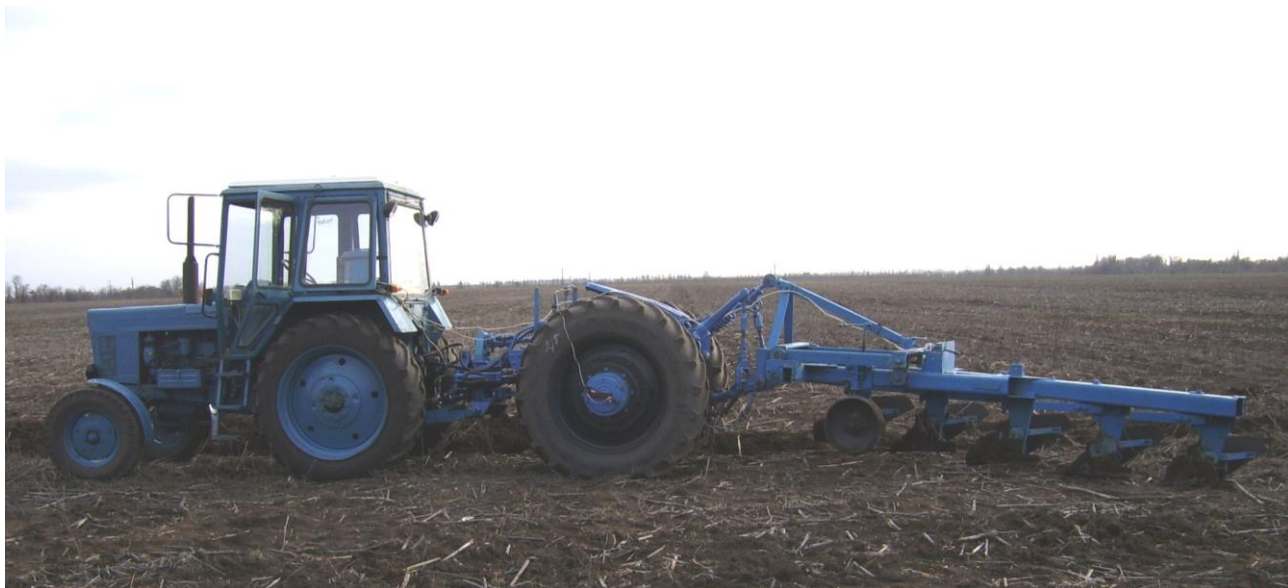
Рис. 3.1. МТА на основі МЕЗ в складі навісного тензометричного плуга.
