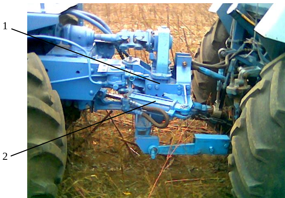
Рис. 3.2. Конструкція переднього поворотного механізму технологічного модуля:
