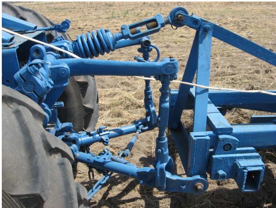
Рис. 3.3. Конструкція заднього навісного механізму технологічного модуля МЕЗ.
