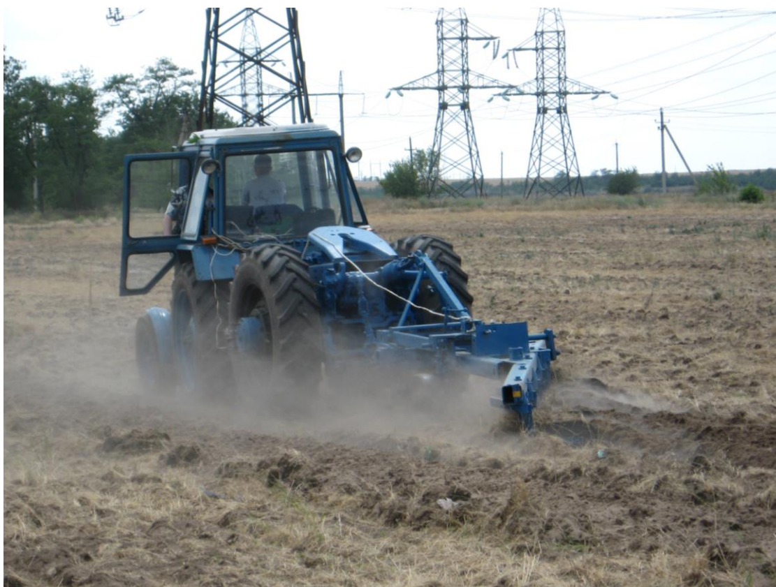
Рис. 4.14. Експлуатаційно–технологічна оцінка орного МТА на основі МЕЗ класу 1,4-3 (агротехнічний фон – стерня зернових).
