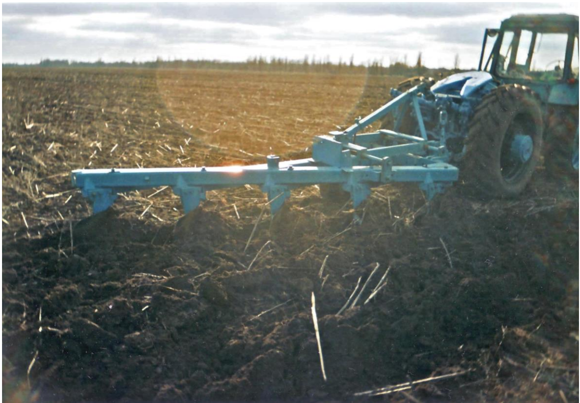
Рис. 4.1. Орний МТА на основі МЕЗ класу 1,4-3 в роботі (агротехнічний фон – стерня соняшника).
