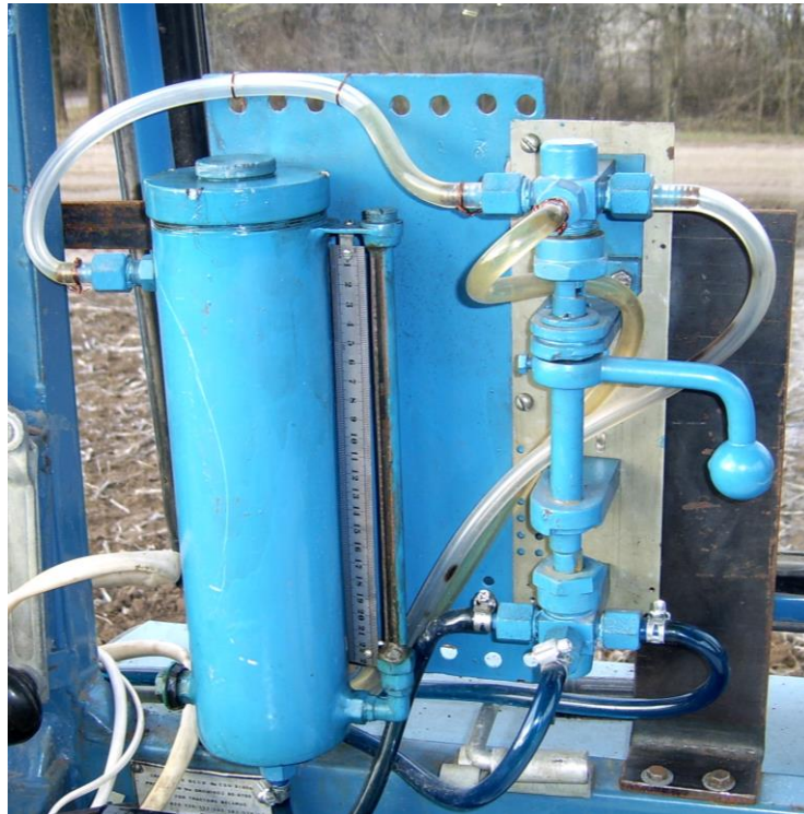
Рис. 3.12. Мірний бачок для виміру витрати палива, який встановлений в кабіні трактора.
