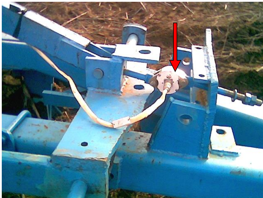
Рис. 3.10. Схема встановлення тензометричної ланки для вимірювання тягового опору плуга.
