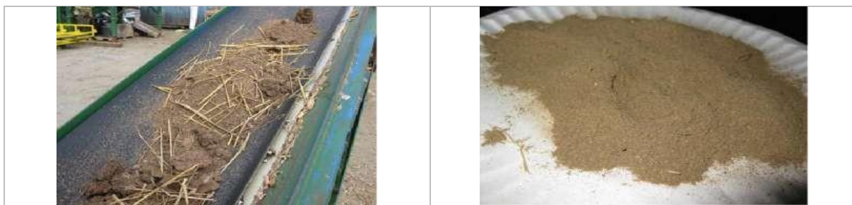
Рис. 2. Підготовка посліду до спалювання за технологією BPS.
