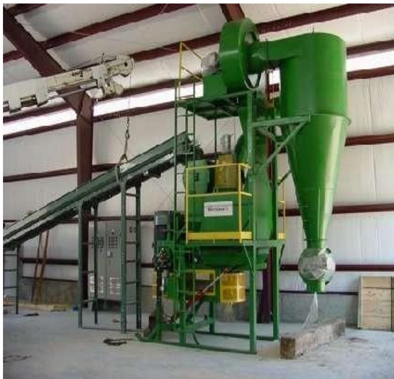
Рис. 1. Комплект обладнання для виробництва подрібненого посліду по технології BPS.
