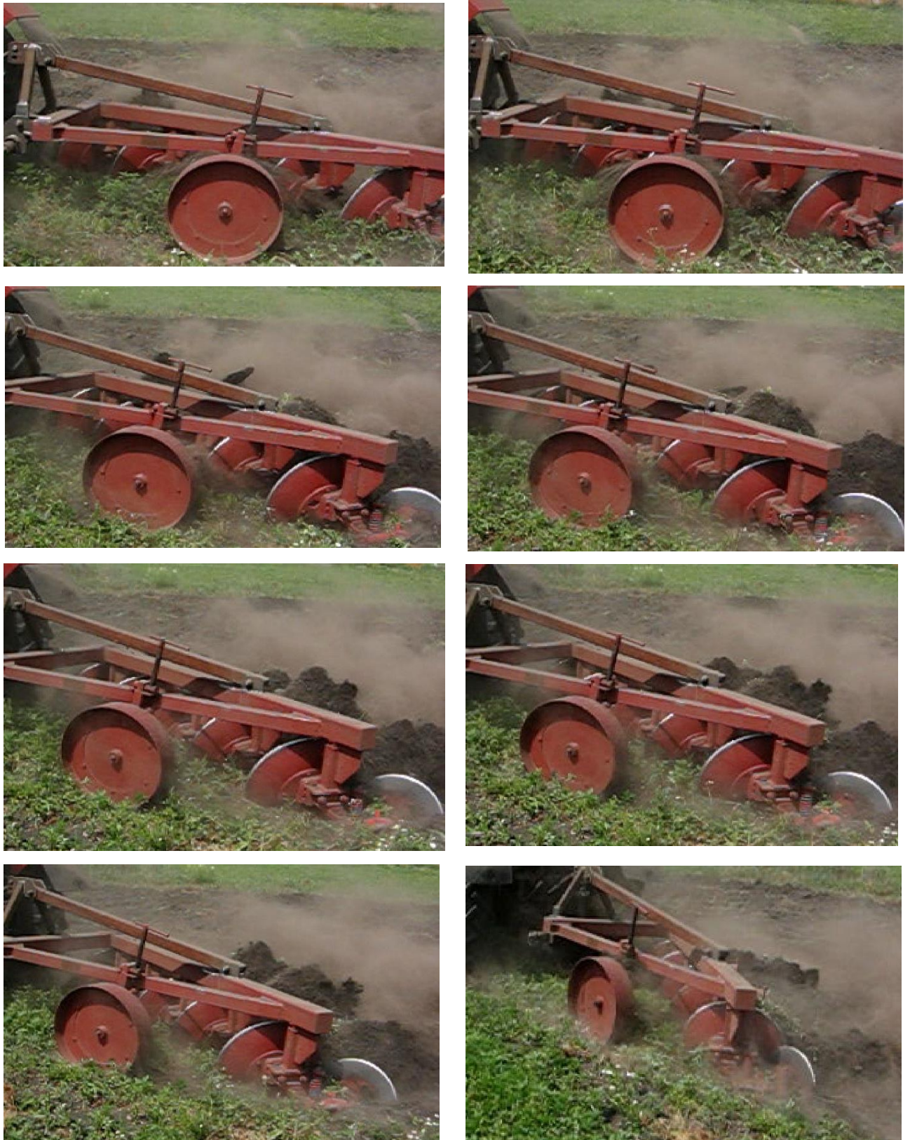
Рис. 3.1 – Фрагменти роботи експериментального дискового п'ятикорпусного плуга конструкції ДП «Гуляйпільський механічний завод» ПАТ «Мотор Січ»
