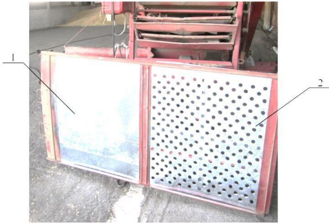
Рис. 3.2 – Експериментальний робочий орган: 1 – суцільне решето (сегрегатор) 2 – решето з отворами
