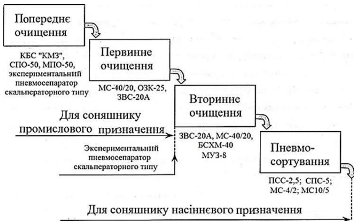
Рисунок 1.3 – Схема технологічна післязбиральної обробки насіння соняшнику
