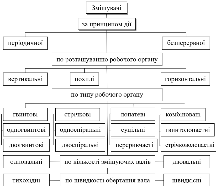
Рисунок 1 – Класифікація пристроїв для змішування дисперсних матеріалів [4]
